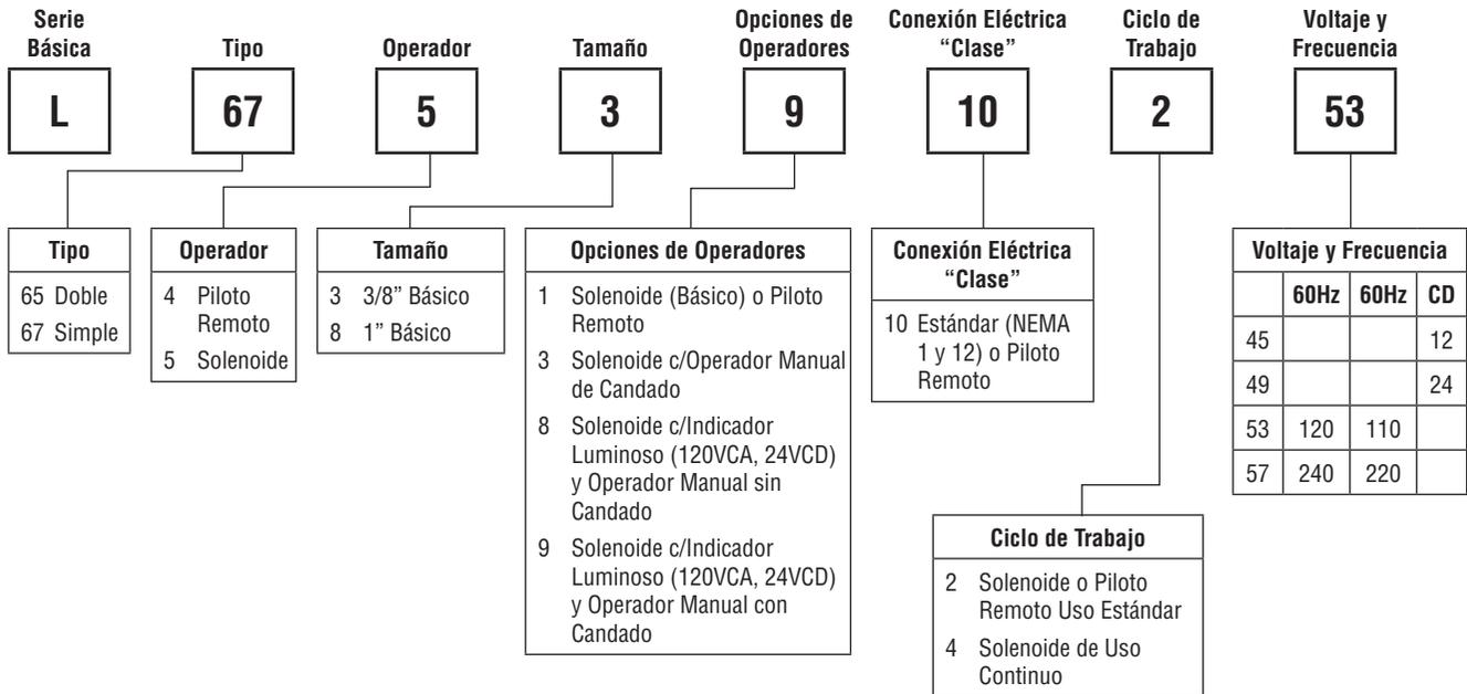
Servicio para Válvula Lubricada o No-Lubricada, de 3 Posiciones, Plug-In, Tamaño 3/8" Básico y 1"
